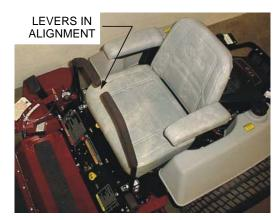
FIGURE 5 LEVER ALIGNMENT
